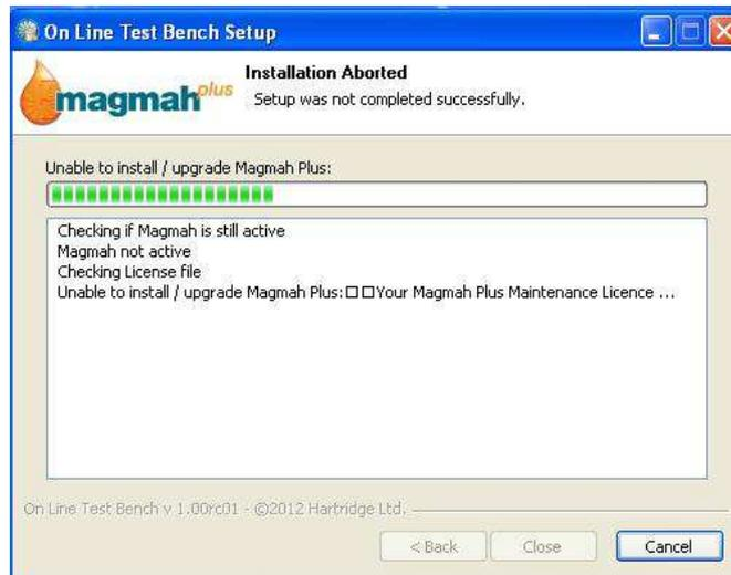
Si la boîte de dialogue ci-dessus s'affiche, cela indique la présence d'un problème avec le fichier de licence de l'installation "Banc d'essai réseau". Le système exige la présence d'une licence de maintenance Magmah valide pour que l'installateur puisse mettre à niveau avec cette option. Veuillez prendre contact avec votre distributeur ou l'assistance technique Hartridge.
