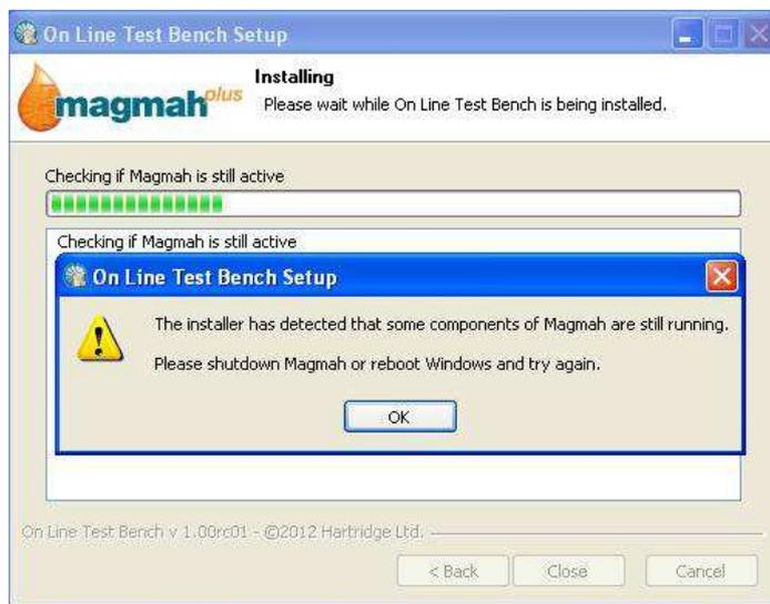
Si la boîte de dialogue figurée ci-dessus s'affiche, c'est que le logiciel Magma est toujours ouvert. Cliquez sur le bouton "OK" puis sur le bouton "Annuler", puis arrêtez complètement Magma avant de relancer une nouvelle fois l'installateur "On Line Test Bench". Le logiciel n'est pas installé et aucune modification n'a été apportée au système.
