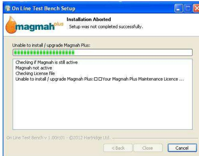
Si aparece el cuadro de diálogo anterior, significa que ha habido un problema con el archivo de licencia para la instalación del "Network Test Bench" (Banco de pruebas de red). Para que el asistente de instalación lleve a cabo la actualización, el sistema requiere una licencia de mantenimiento de Magmah válida. Póngase en contacto con su distribuidor o con el departamento de asistencia al cliente de Hartridge.
